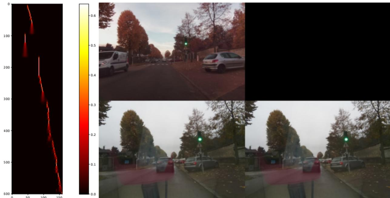
**FIGURE** – Requête image noIR vers visible à long terme sans filtre (à gauche) et avec filtre bayésien (à droite)
