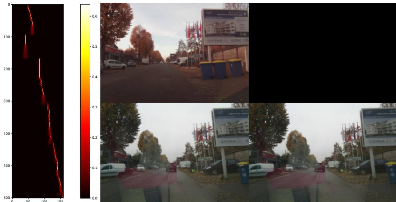
**FIGURE** – Requête image noIR vers visible à long terme sans filtre (à gauche) et avec filtre bayésien (à droite)
