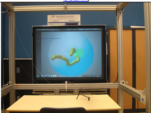
Un utilisateur manipule un objet virtuel en utilisant un système SPIDAR à retour d'effort sur EVR@-TR ( projet A.S.T.R.E. 2005-2007 )
