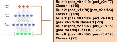
Approche décompositionnelle : analyse la topologie et les poids des connexions du réseau de neurones afin d'extraire des règles.
