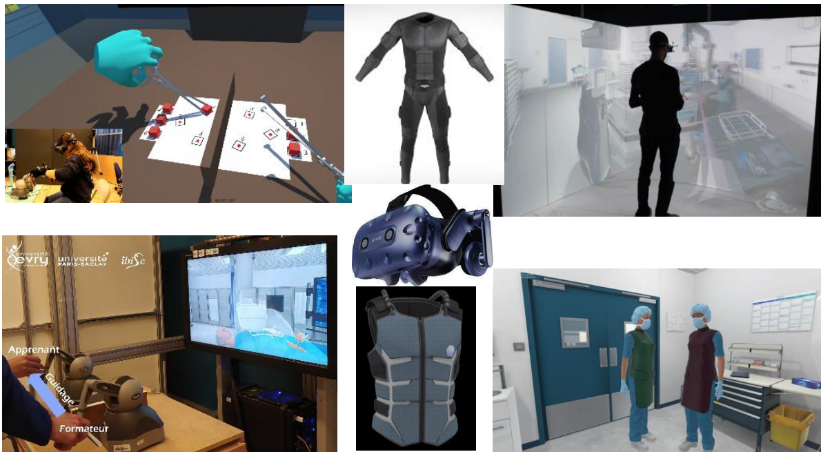
Figure 1 : Exemples des simulations et technologies présentes sur la plateforme EVR@ (CAVE, casques, systèmes de eye tracking, gants de données, bras à retour d'efforts, écrans tactiles, vestes haptiques...)
