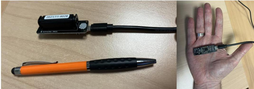
Fig. 3 : Interface vibrotactile Hapcoil One (Actronika) disponible au laboratoire et fondée sur les signaux audio
