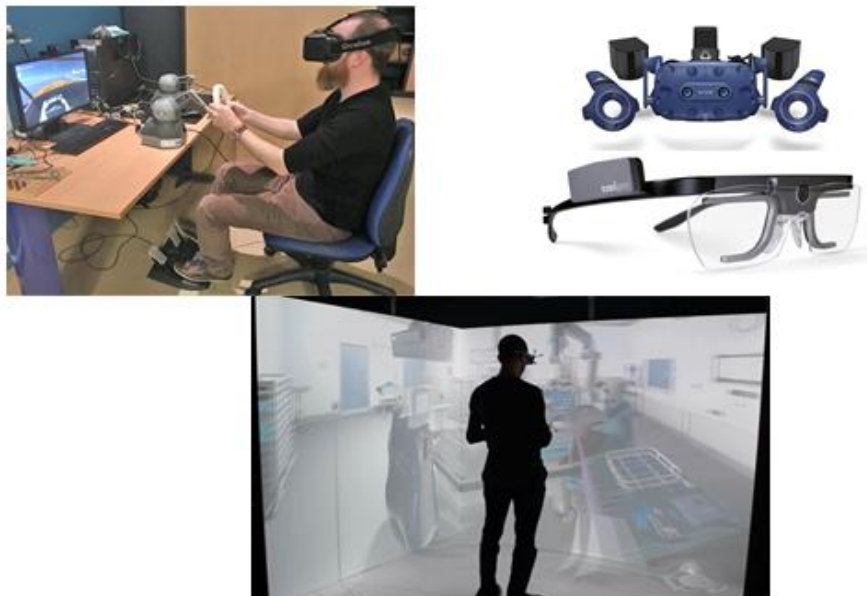
Fig1. Exemples de simulations et technologies présentes sur les plateformes IBISC (CAVE, casques, bras à retour d'efforts, oculomètres...)
