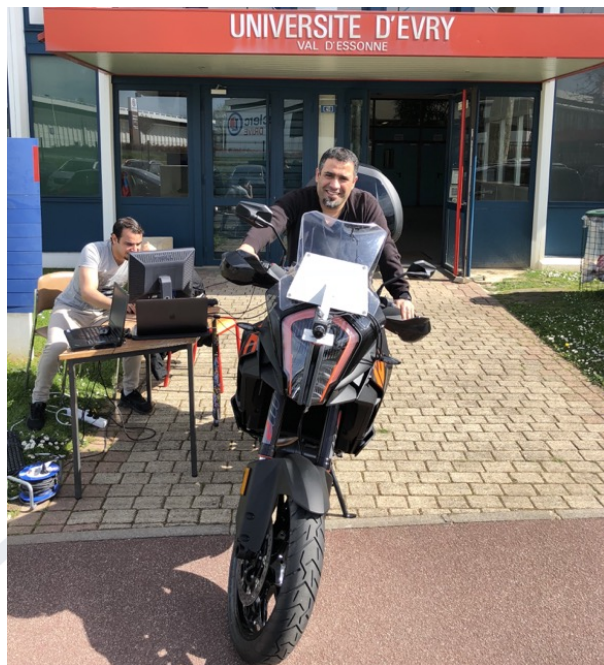
FIGURE 5.11 – Moto KTM 1290 S Adventure munie d'un système de perception visuelle.
