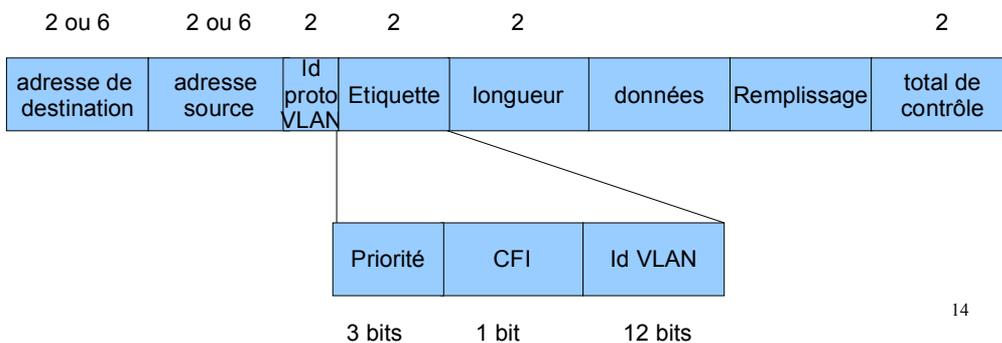
un VLAN est associé à chaque trame. Pour rendre possible la détermination de ce VLAN dans tous les cas, accélérer le traitement, on peut imaginer d'ajouter un identifiant de VLAN à chaque trame. C'est ce que propose la norme IEEE 802.1Q.
